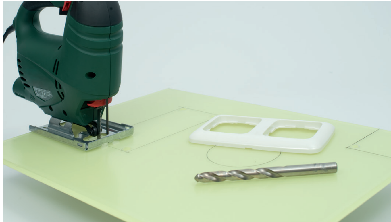
Aussparungen und Öffnungen in den Schnittkantenecken stets vorbohren und mit einer Stichsäge oder Oberfräse herausarbeiten.
